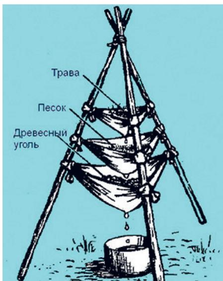
Берёте чистый носок. Вкладываете в него слой древесного угля. Затем – слой песка. Сверху – слой травы. Трава отлавливает крупные частицы, песок продолжает фильтрацию, а уголь поглощает вредные примеси. Наливаем в такой носок воду и подвешиваем, чтобы она стекала.
